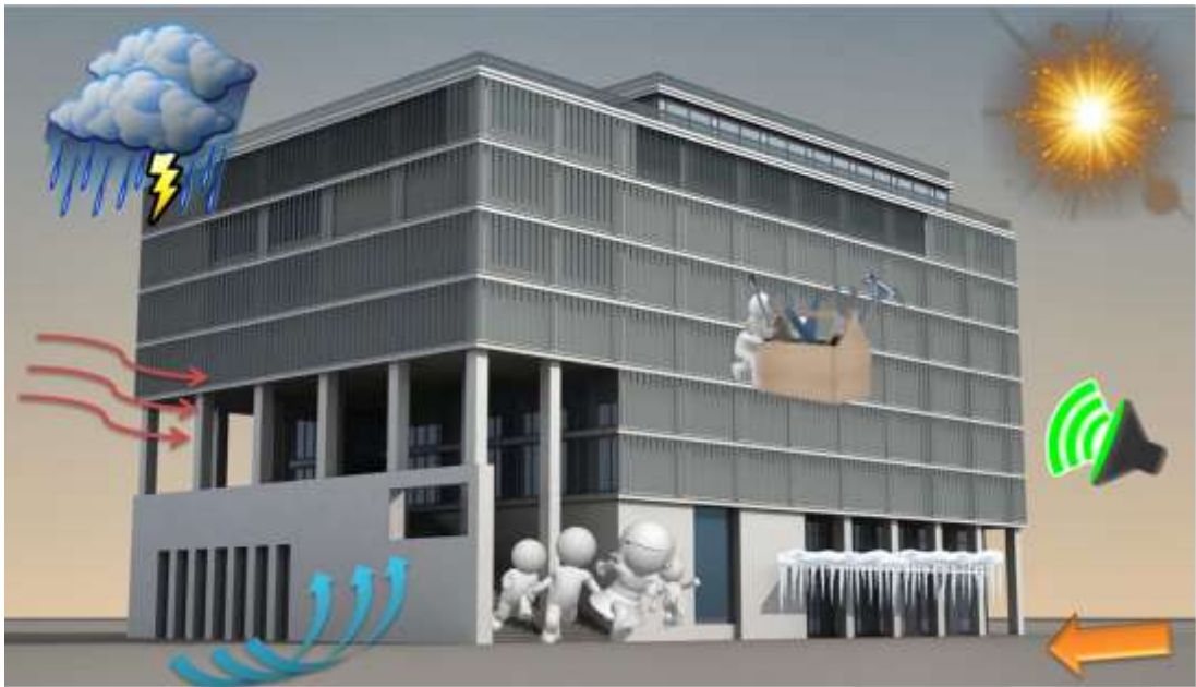
Рисунок 7 – Схема нагрузок действующих на здание
